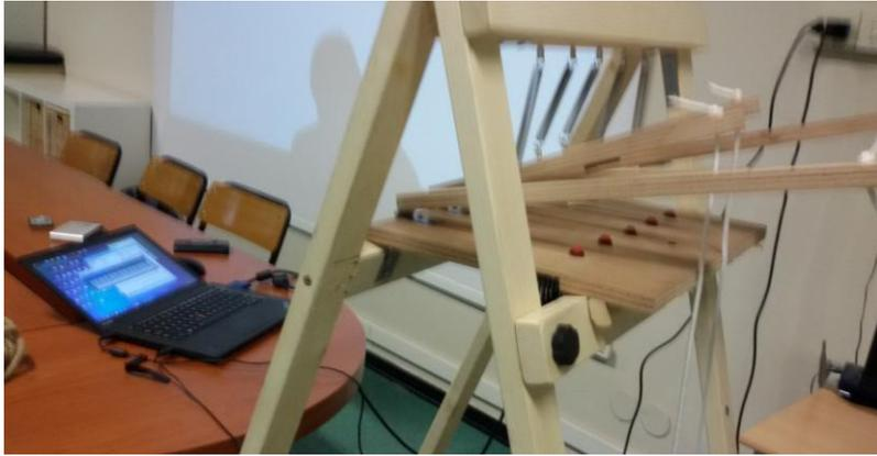
Questo è uno strumento creato appositamente per poter suonare le campane senza disporre di campane. Un telaio in legno dotato di un sistema di aste, corde e
